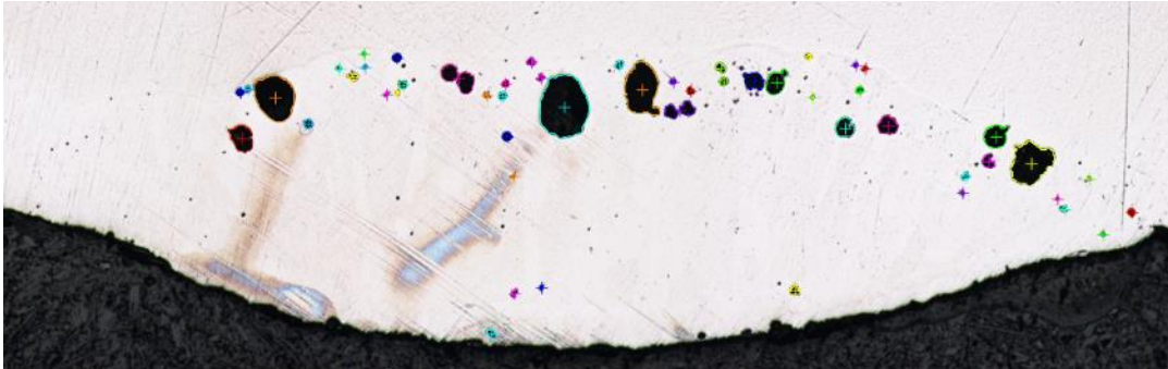
Figura nº 4. Muestra 4_E1, medición de porosidades mediante analizador de imágenes.
