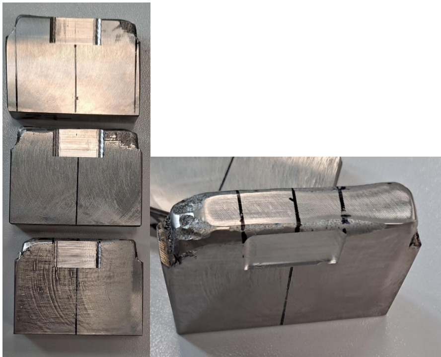
Imagen 27. Desarrollo de probetas de tracción donde se mecanizan en primer lugar la zona calibrada para posteriormente extraer la propia probeta.
