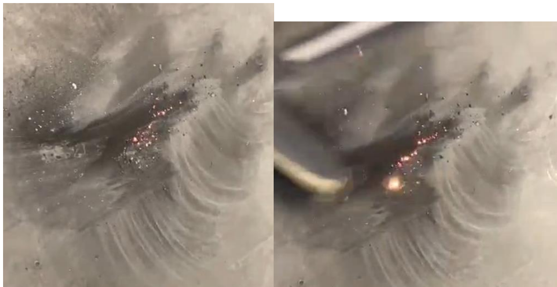
Imagen 40. Detalle de la deflagración del polvo depositado en el suelo
