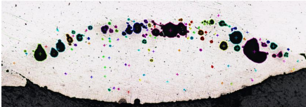
Figura nº 7. Muestra 7_E1, medición de porosidades mediante analizador de imágenes.
