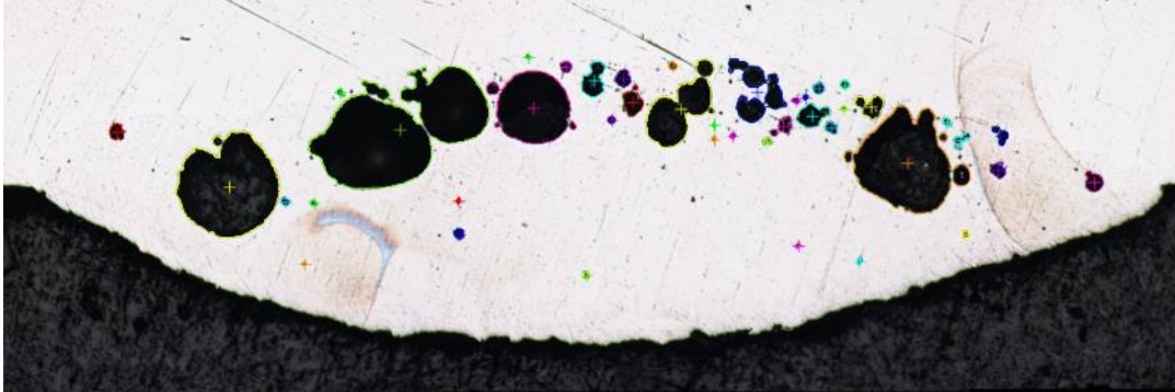
Figura nº 2. Muestra 2_E1, medición de porosidades mediante analizador de imágenes.
