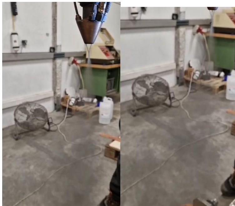
Imagen 39. Detalle de la volatilidad del polvo que queda en suspensión tras la salida de este por la boquilla de deposición.
