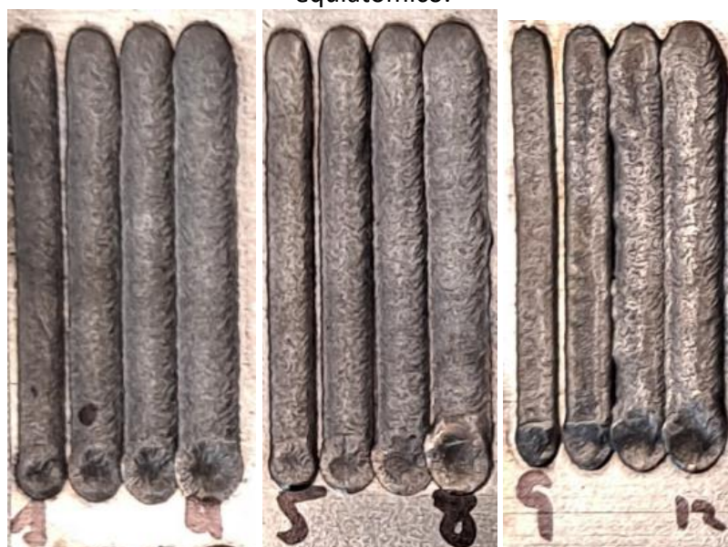
Imagen 4. Cupón obtenido para determinar los parámetros analizados del material equimásico.
