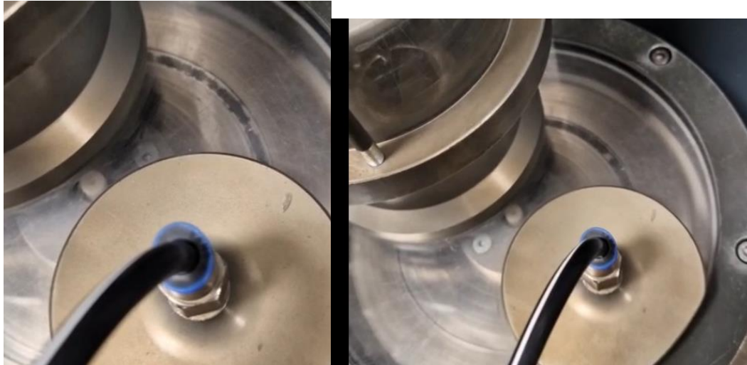
Imagen 38. Detalle del canal de distribución del polvo donde se aprecia un flujo discontinuo de alimentación.
