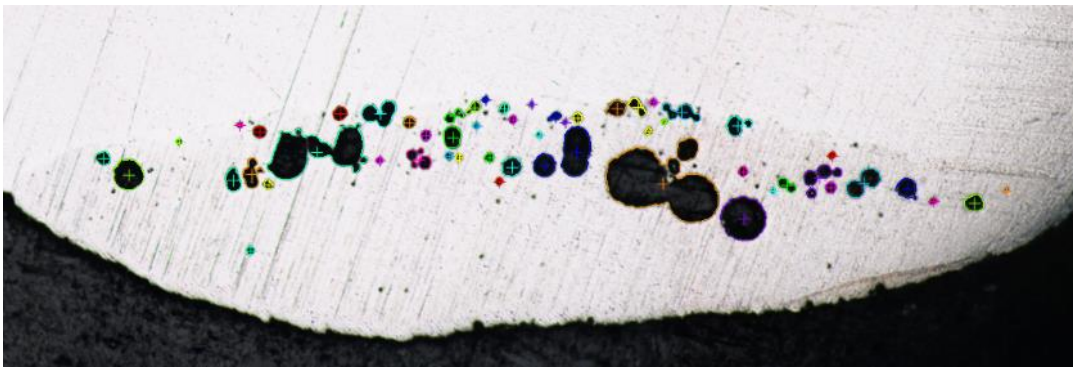
Figura nº 1. Muestra 1_E1, medición de porosidades mediante analizador de imágenes.
